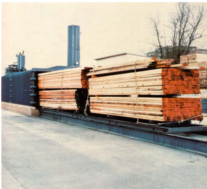
Figura 1. Planta de tratamento com autoclave de seção transversal retangular, utilizada para o tratamento da madeira pelo processo duplo-vácuo .
